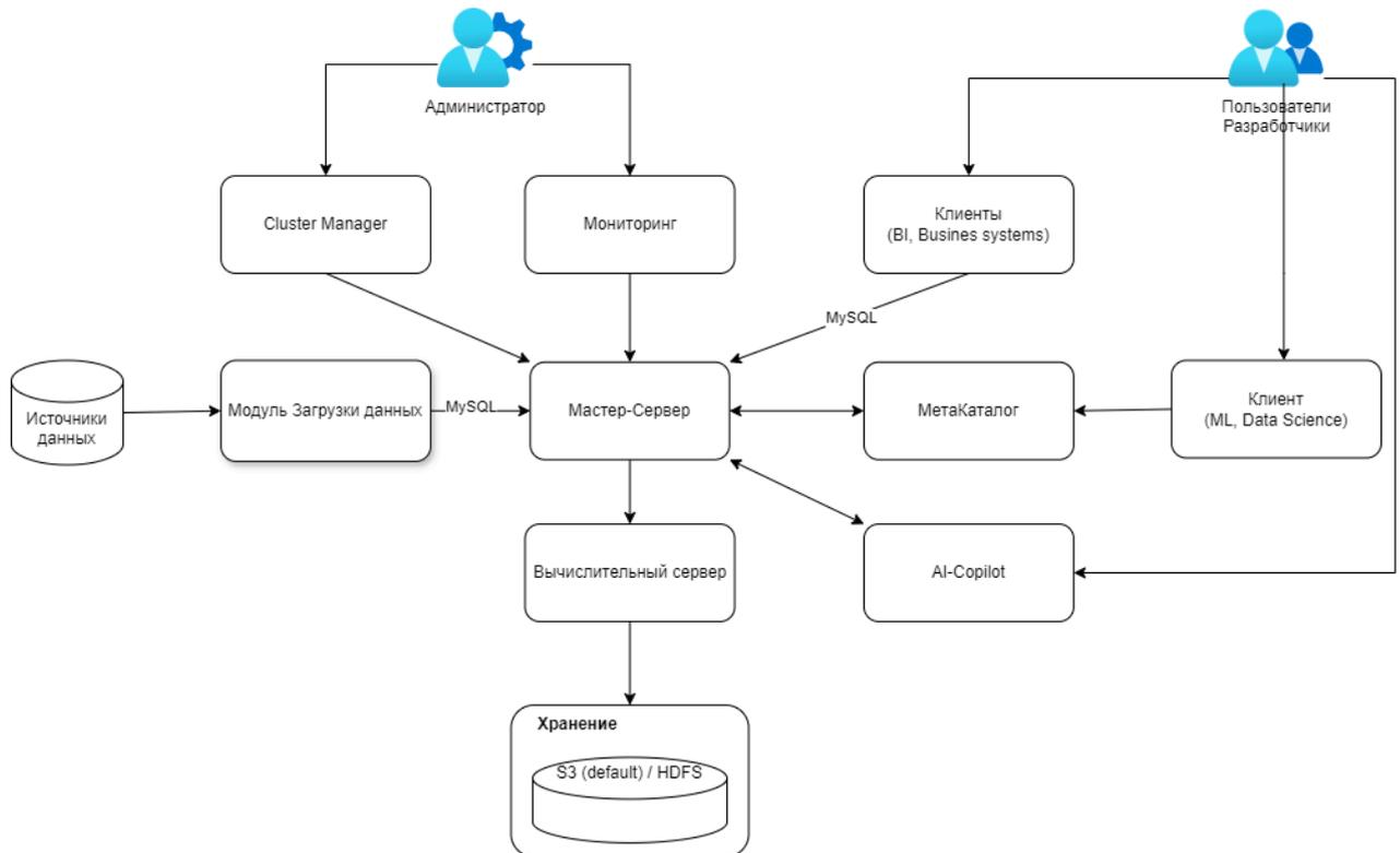
Рисунок 1 - Архитектура и компоненты Платформы Данных Селена
